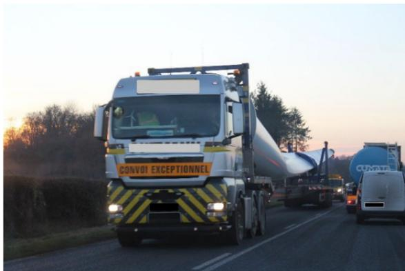
Photo 4 : Transport d'une pale d'éolienne
